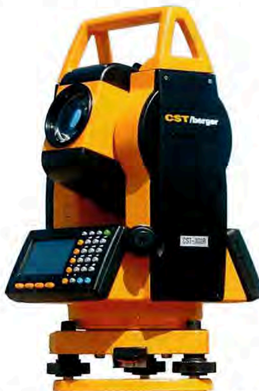
Рисунок 1 - Внешний вид тахеометров электронных CST/berger CST-302R, CST/berger CST-305R
